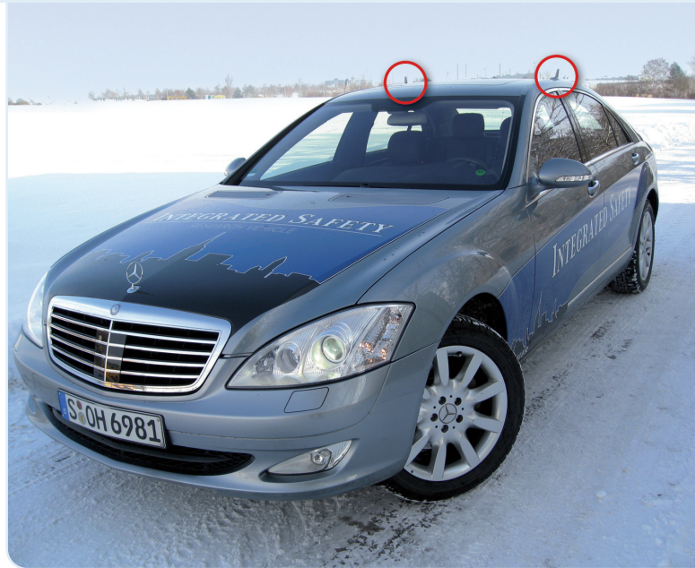
Die SAFESPOT-Nachrichten werden über die im Foto rot markierten Antennen versendet und empfangen.
